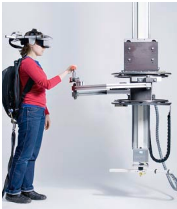
Haptische Erfassung: Ein künstlicher Arm simuliert das Berühren von Gegenständen.
